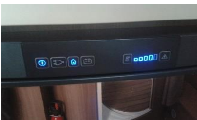
Utilisation de réfrigérateur Dometic avec choix d'énergie manuel
