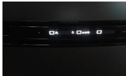
AES réfrigérateur Dometic, choix d'énergie automatique
