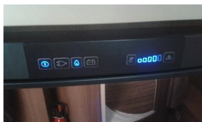
Bediening Dometic koelkast met manuele energiekeuze
